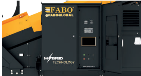
Renkli ekranlı, kullanıcı dostu PLC kontrol sistemi
