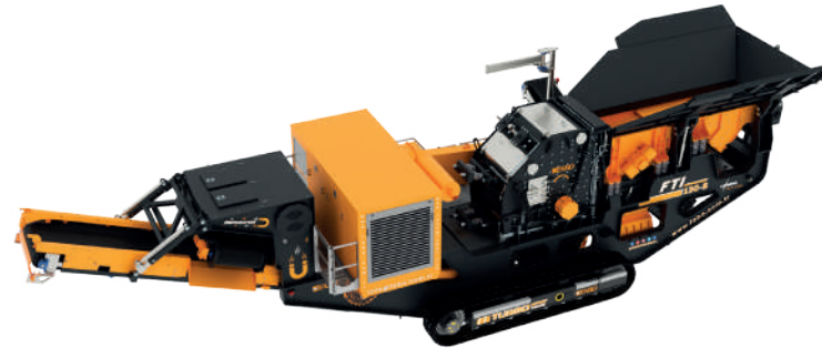
Uzaktan kumandalı paletli yürüyüş sistemi ile en zorlu arazi ve iklim koşullarında bile altyapı gerektirmeden sahada hareket eder.
