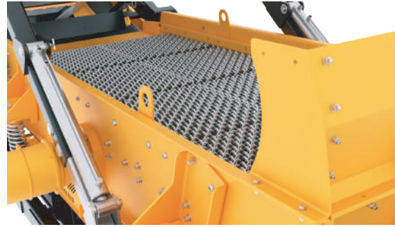
Dayanıklı elek sacı ve değiştirilebilir elek telleri, titreşime karşı yüksek dayanım sağlar.
