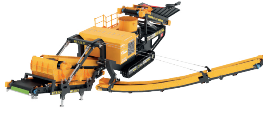
90 derece döndürülebilir bant, hem geri dönüş bandı olarak kullanılabilir hem de stok bandı görevini görür.
