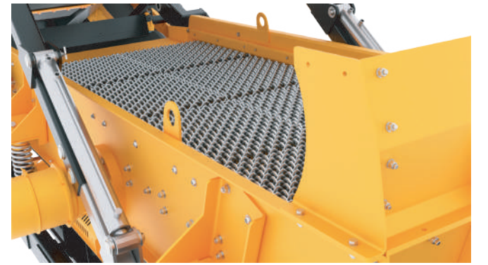
Dayanıklı elek sacı ve değiştirilebilir elek telleri, titreşime karşı yüksek dayanım sağlar.
