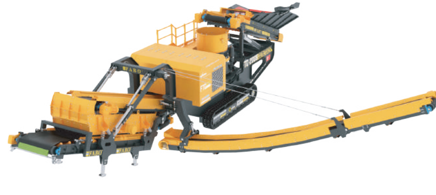
90 derece dönebilen bant, geri dönüş bandı olarak kullanılabilir ve stok bandı görevini görebilir.
